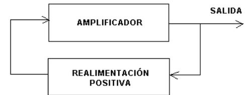
Esquema en bloques de un oscilador
